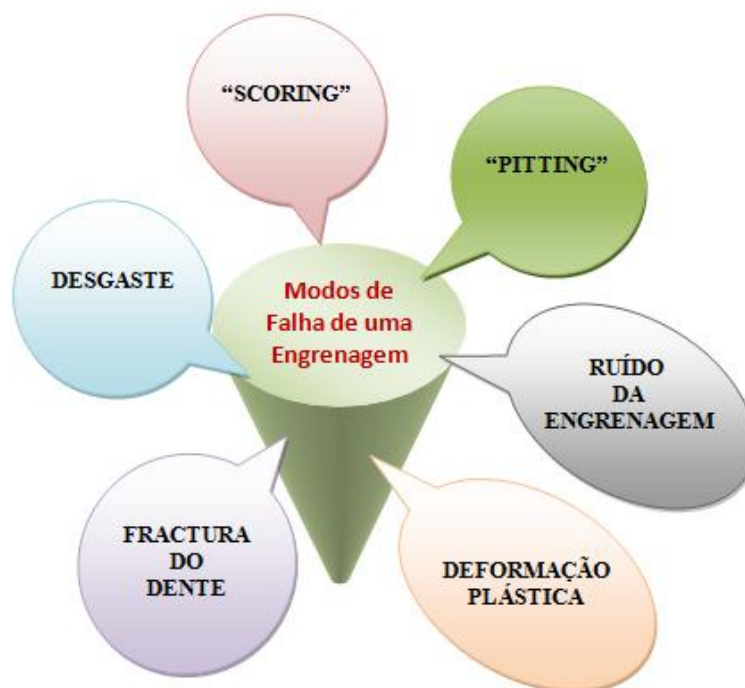
Fig.5. Modos de falha mais comuns em engrenagens metálicas
