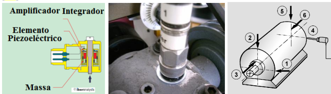
Fig.47. Acelerómetro de corte uniaxial usado nos ensaios e posição do acelerómetro
