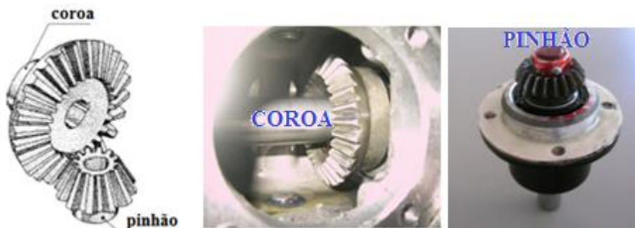
Fig.2. À esquerda: representação de um par de engrenagens cónicas [15]; à direita: imagem da coroa e do pinhão das caixas redutoras testadas em laboratório
