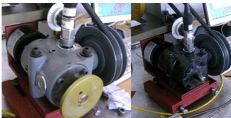
Fig.1. À esquerda: caixa redutora em bom estado; à direita: caixa redutora com desgaste
