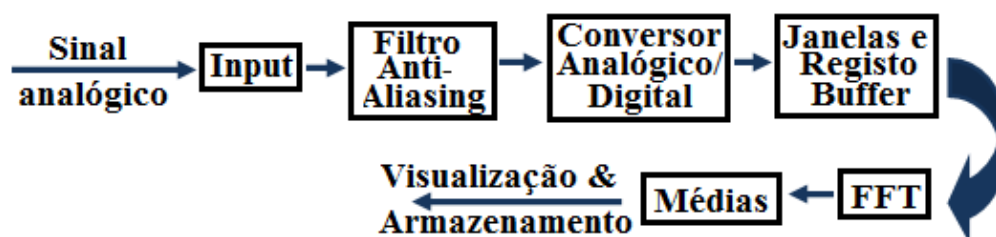
Fig.12. Diagrama de blocos do processo de cálculo da FFT
